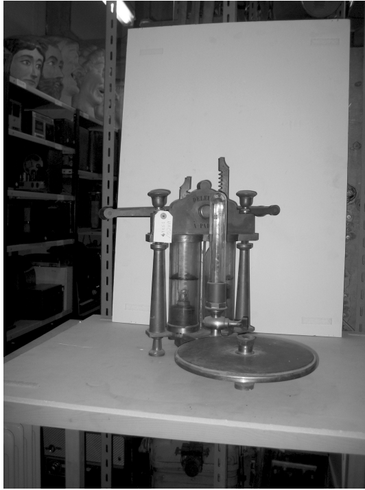
Figura 1. Màquina pneumàtica amb el sistema de Babinet (JVV-0026).
